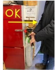
**FASE 2** - Collegare il serbatoio arma alla bombola tramite i raccordi personali →
